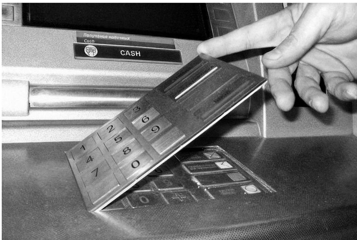
**Скиммер** – специальное устройство, которое используется для считывания данных магнитной полосы пластиковых банковских карт. В большинстве случаев скиммеры крепятся непосредственно к банкомату, а именно к слоту картоприемника. При этом заметить наличие скиммера сможет лишь хорошо обученный и наблюдательный человек, у большей части граждан не возникнет никаких опасений.
