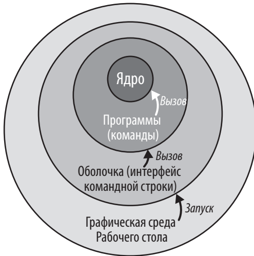
Рис. 1.1. Четыре основных компонента Linux. Низкоуровневые функции ядра вызываются программами, которые вызываются в оболочке. В свою очередь, оболочка может быть запущена из графической среды Рабочего стола
